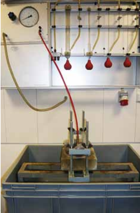
Prüfvorrichtung für rückseitige Wasserbelastung von MDS.
